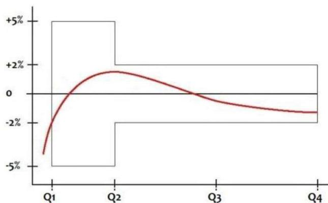
**Max. Error permitido para temperatura 30°: / Max. Permission error for temperature 30°:**
