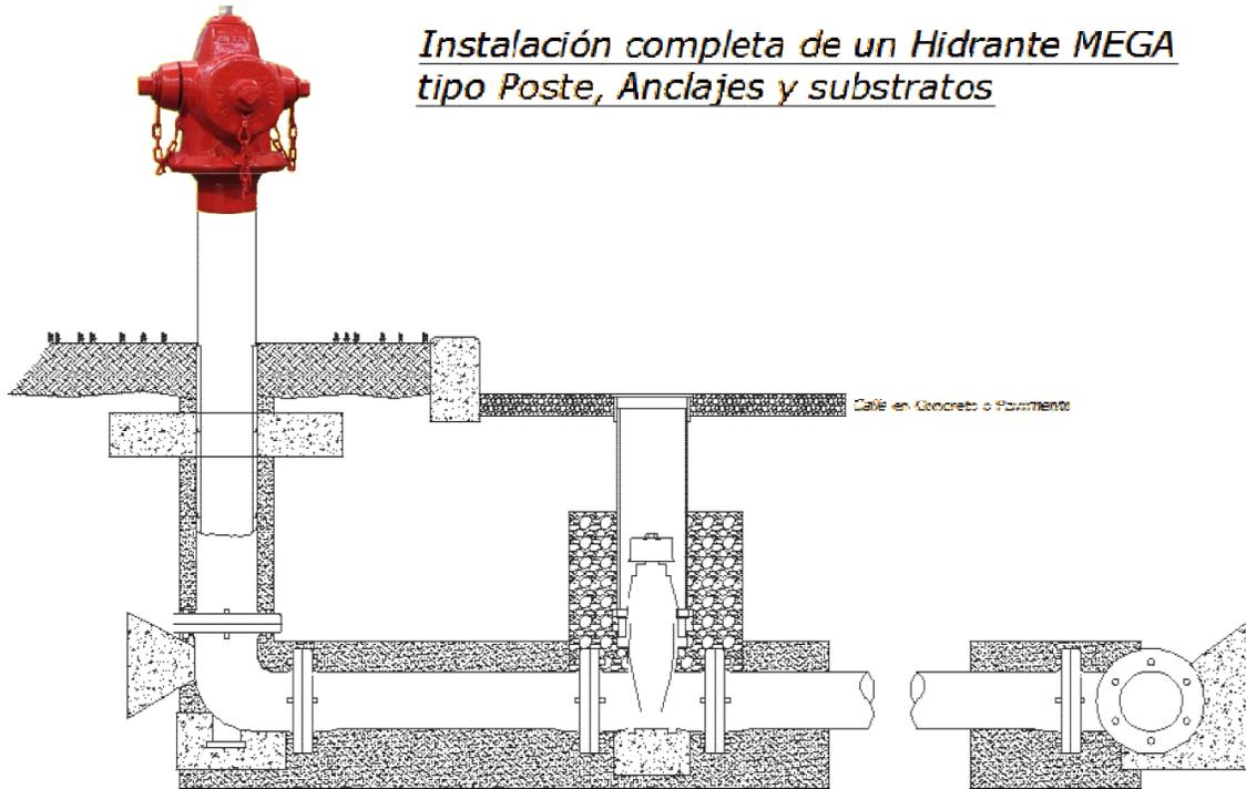
*Instalación completa de un Hidrante MEGA tipo Poste, Anclajes y substratos*
